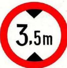
Dieses Zeichen zeigt an, dass das Fahren mit Fahrzeugen, deren größte Höhe die im Zeichen angegebene Höhe überschreitet, verboten ist. Es kann oberhalb der Fahrbahn entsprechend der vorhandenen Höhe angebracht werden.
